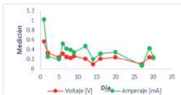
Figura 3. Amperaje y voltaje obtenidos en la celda operada con glucosa
