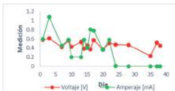
Figura 3. Amperaje y voltaje obtenidos en la celda operada con glucosa
