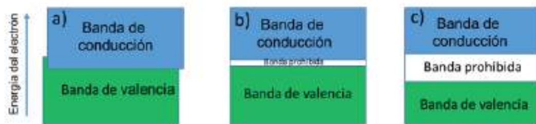
Figura 1. Diagrama de bandas, a) Metales, b) Semiconductores y c) Aislante
