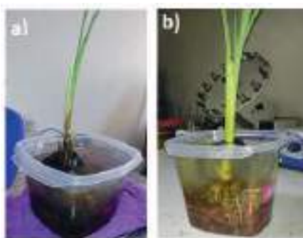
Figura 2. Celdas de combustible vegetales operadas con a) glucosa y b) acetato de sodio
